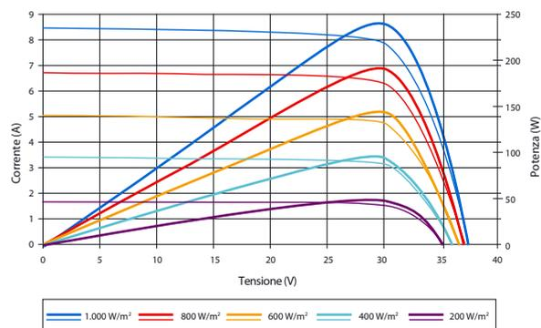
Prestazioni eccellenti anche in condizioni di bassa irradiazione: ad una intensità di irradiazione di 200 W/m<sup>2</sup> (AM 1,5 e 25 °C), si raggiunge il 95.5% o più della efficienza in STC (1000 W/m<sup>2</sup>)
